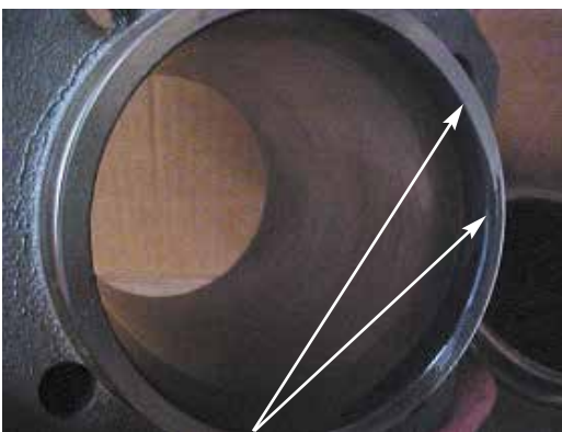
Fig. 5.1.5 Apoio irregular entre a parte superior da camisa e o cabeçote
