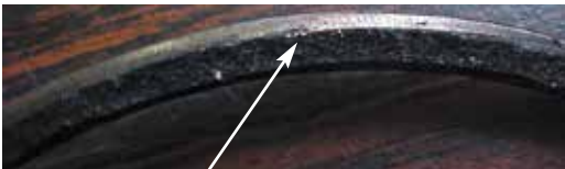
Fig. 5.1.4 Região do colarinho da camisa carbonizado
