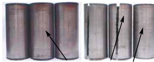
Fig. 5.2 Camisa com marcas da usinagem do bloco
