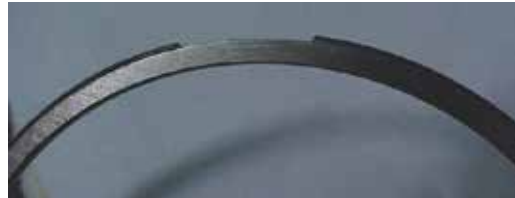
Fig. 3.4.2 Face de contato lascada
