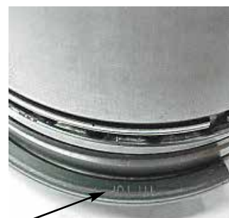
Fig. 3.1.1 Marca do anel montado para o lado de baixo
