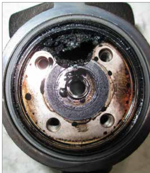
Fig. 13.3.3 – Carbonização do óleo lubrificante decorrente de temperatura elevada.
