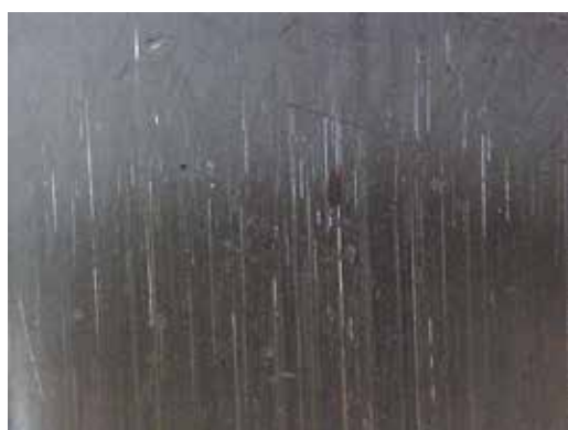
Fig. 8.2.7 Foto ampliada dos riscos e dos corpos estranhos na bronzina
