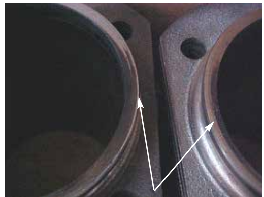
Fig. 4.1.5 Apoio irregular da camisa com o cabeçote
