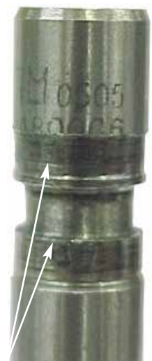
Fig. 11.4.4 Desgaste na região do canal de trava provocado por irregularidade na trava
