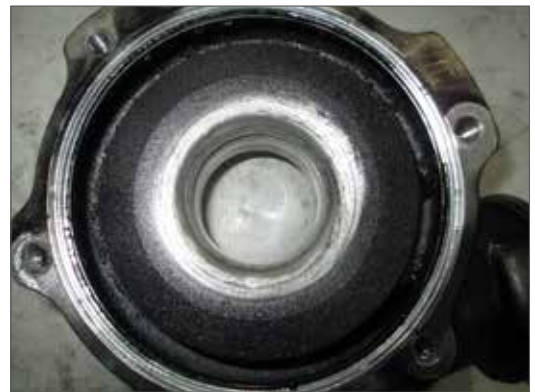
Fig. 13.4.3 – Borra de óleo na carcaça compressora.
