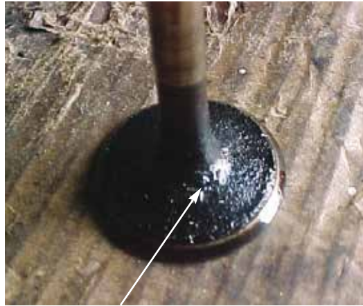
Fig. 11.9.3 Válvula de admissão com contaminação de crosta de óleo lubrificante devido à folga excessiva entre guia e haste e/ou deficiência do retentor/vedador
