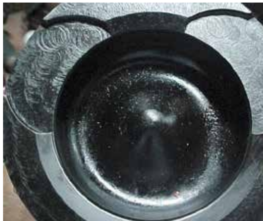
Fig. 2.13.2 Marcas de usinagem do topo do pistão e rebaixo de válvulas
