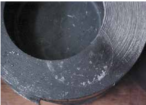
Fig. 2.8.1 Marca de válvula no topo usinado do pistão
