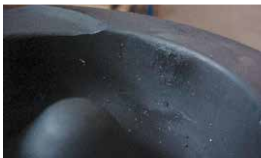
Fig. 2.6.1 Pulverização ocorrendo parcialmente fora da câmara de combustão
