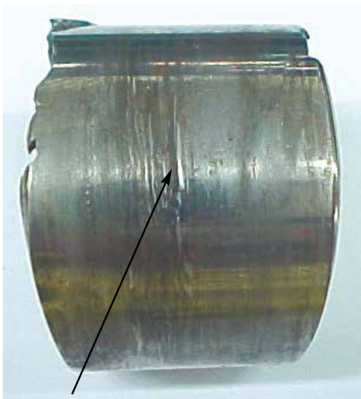
Fig. 10.3.1 Marca do embuchamento incorreto
