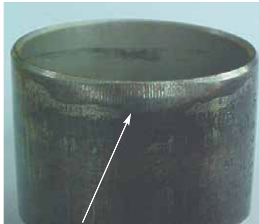
Fig. 10.3.2 Marca do embuchamento inclinado
