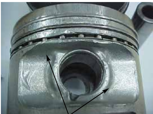
Fig. 1.1.1 Danos provocados pela trava
