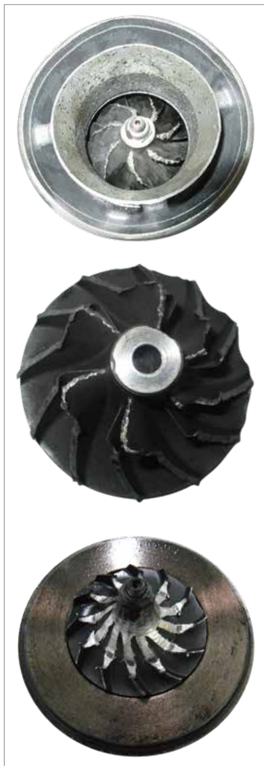
Fig. 13.2.2 (1), Fig. 13.2.2 (2) e Fig. 13.2.2 (3) – Admissão de corpo sólido
