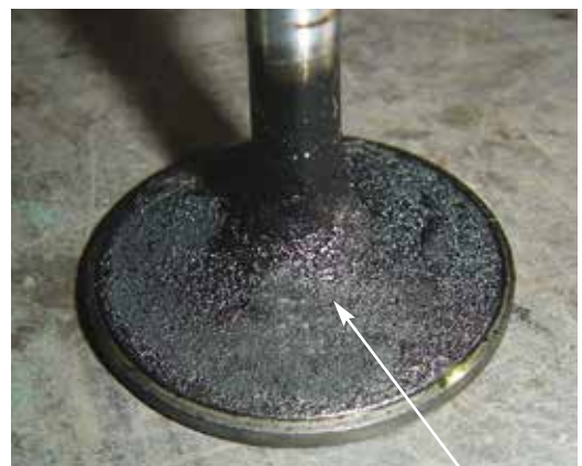
Fig. 11.9.2 Válvula de admissão contaminada com óleo lubrificante devido a folga excessiva entre a haste e a guia ou retentor/vedador deficiente
