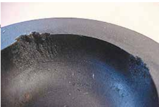
Fig. 2.7.1 Destruição parcial da câmara de combustão
