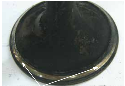
Fig. 11.9.1 Faixa irregular de assentamento
