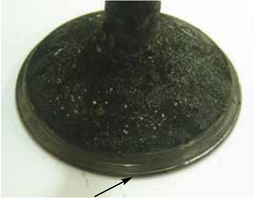
Fig. 11.2.2 Desgaste na região do assento da válvula
