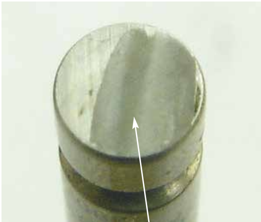
Fig. 11.9.5 Marcas que indicam que a válvula não girou. Deficiência do balancim
