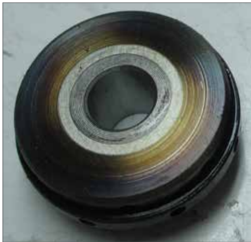
Fig. 13.1.1.4 – Lubrificação deficiente no colar centrífugo.
