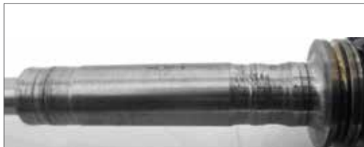
Fig. 13.1.1.5 – Desgaste causado por baixa pressão de óleo lubrificante.
