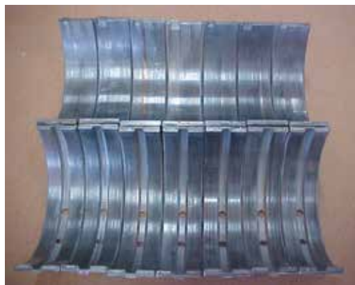
Fig. 8.2.4 Bronzinas de mancal contaminadas e com riscos circunferenciais
