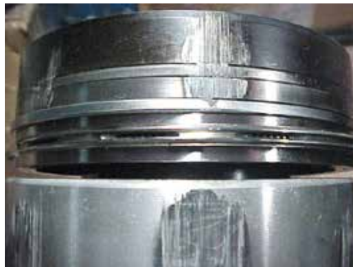
Fig. 2.7.3 Engripamento iniciado na zona de fogo, estendendo-se para a região da saia do pistão
