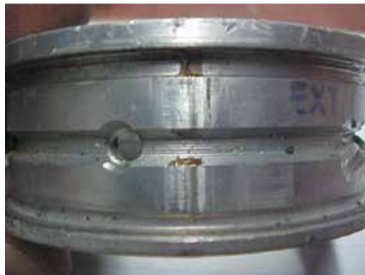
Fig. 8.13 Cola/adesivo no canal de lubrificação externa da bronzina
