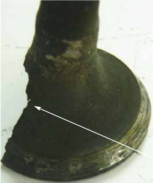
Fig. 11.6.2 Quebra de parte da cabeça
