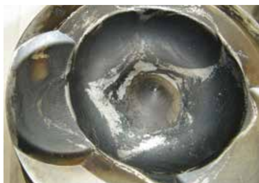
Fig. 2.6.3 Pulverização irregular do bico injetor
