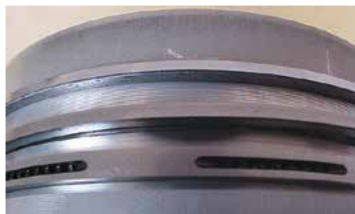
Fig. 3.5.6 Anel da terceira canaleta desgastado
