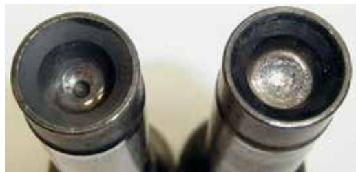
Fig. 12.4.5 – Mosca com apoio irregular da vareta de válvulas
