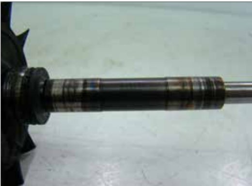
Fig. 13.1.1.2 – Lubrificação deficiente no eixo rotor.
