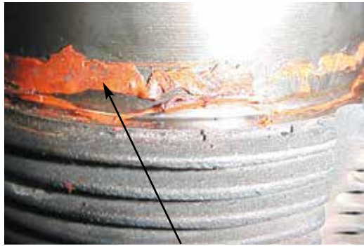
Fig. 4.1.2 Silicone na base inferior da camisa
