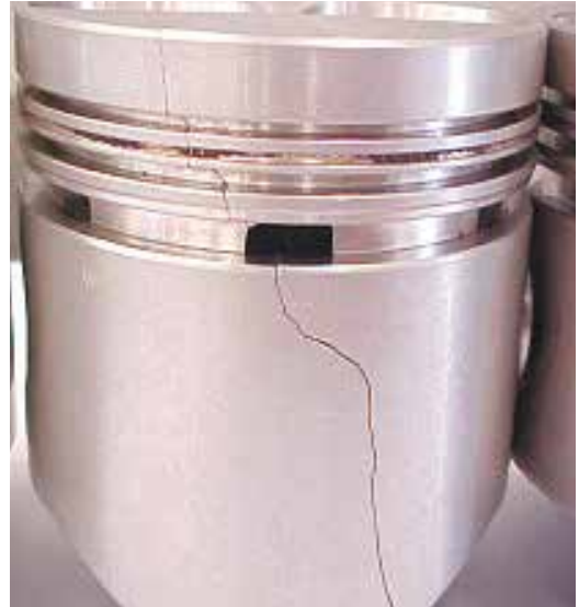
Fig. 2.14.3 Peça trincada durante o embielamento
