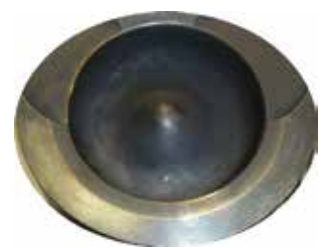
Fig. 2.13.4 Usinagem do rebaixo de válvulas
