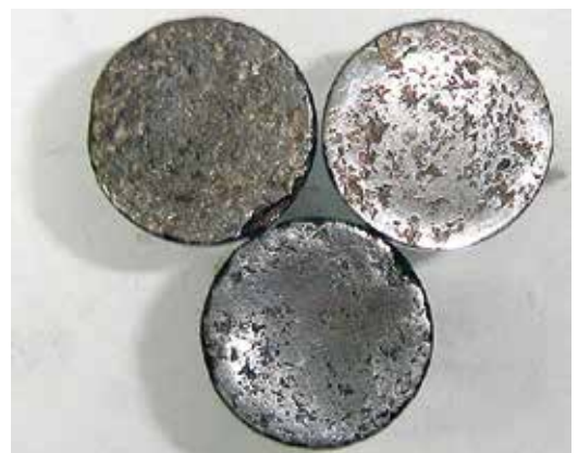
Fig. 12.3.1 – Desgaste e deformação da base
