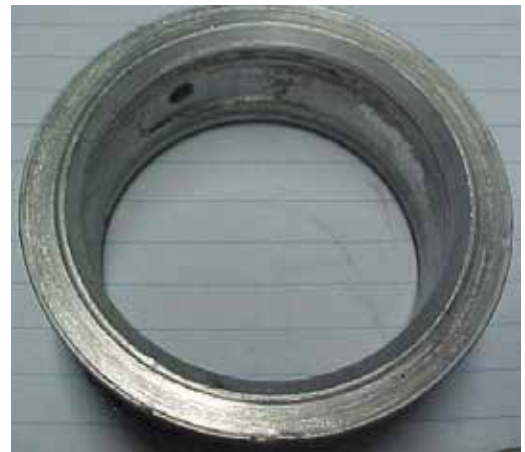
Fig. 8.1.2 Flange totalmente desgastado
