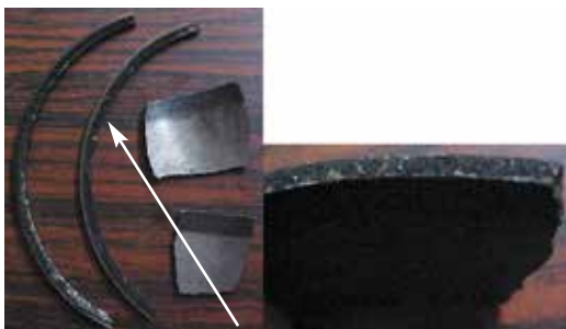
Fig. 5.1.2 e 5.1.3 Camisa seca. Região do colarinho da camisa carbonizado
