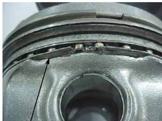
Fig. 1.1.2 Danos provocados pela trava
