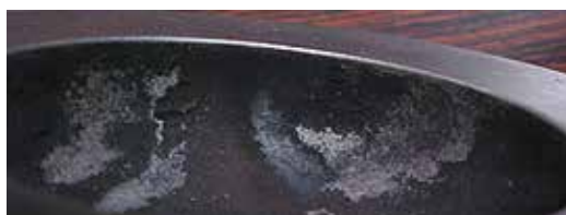
Fig. 2.6.2 Pulverização ocorrendo parcialmente fora da câmara de combustão
