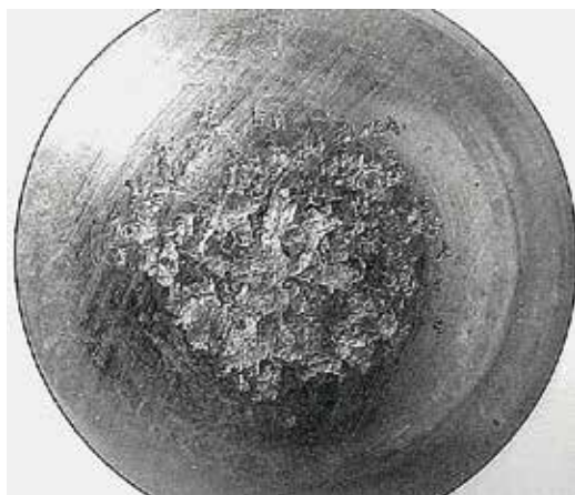
Fig. 12.2.1 – Pitting ocorrido somente no centro da base
