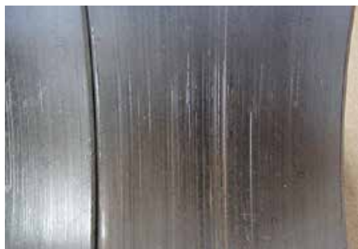
Fig. 8.2.6 Bronzinas de biela contaminadas e com riscos circunferenciais
