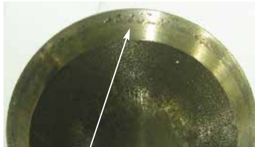
Fig. 11.7.2 Desgaste na região da cabeça da válvula
