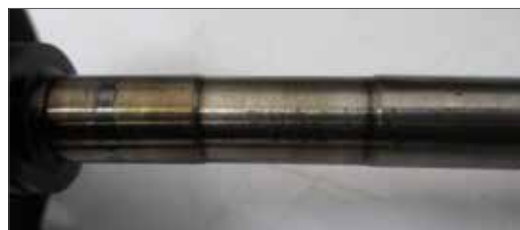
Fig. 13.1.1.6 – Marcas circulares no eixo, indício de parada a quente.
