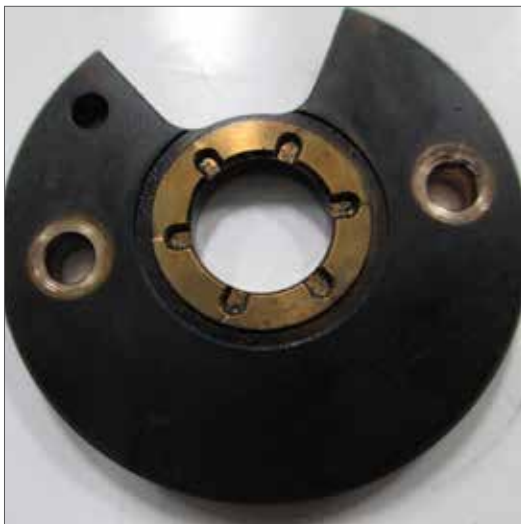
Fig. 13.3.1 – Carbonização do óleo lubrificante decorrente de temperatura elevada.
