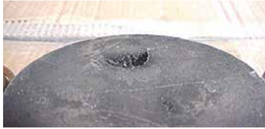
Fig. 2.7.6 Destruição parcial do topo devido à injeção
