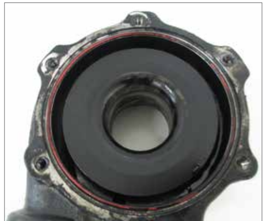
Fig. 13.5.3 – Óleo lubrificante na carcaça compressora, provocado por restrição de ar.
