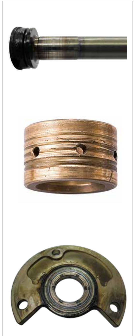
Fig. 13.1.2.4 (1) – Óleo lubrificante contaminado, (Foto 08) – Eixo rotor; mancal radial e espaçador e Fig. 13.1.2.4 (3) – Óleo lubrificante contaminado
