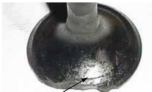
Fig. 11.5.1 Parte da cabeça quebrada
