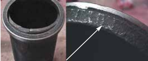
Fig. 5.1 e 5.1.1 Camisa molhada. Região do colarinho da camisa rompido e carbonizado
