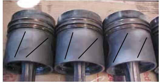
Fig. 1.3.1 Marcação inclinada na região da saia do pistão
