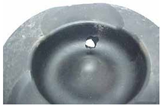
Fig. 2.7.10 Destruição do topo e da região do cubo devido ao bico injetor irregular
