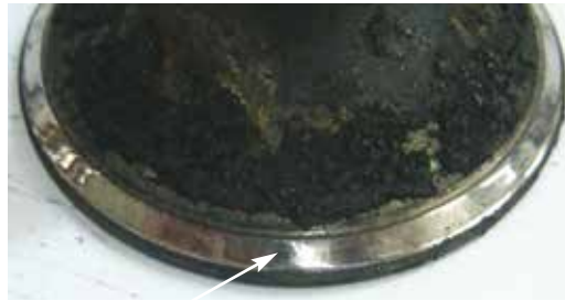
Fig. 11.7.1 Desgaste na região da cabeça da válvula
