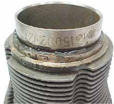
Fig. 4.1.4 Camisa montada com cola na base inferior
