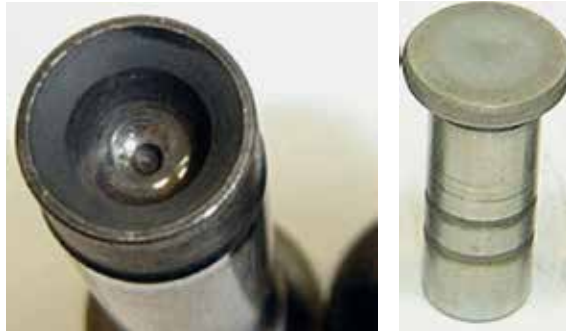
Tucho mecânico com desgaste normal de funcionamento
