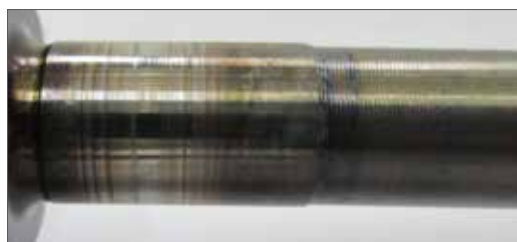
Fig. 13.1.2.2 – Riscos provocados por óleo lubrificante contaminado.
