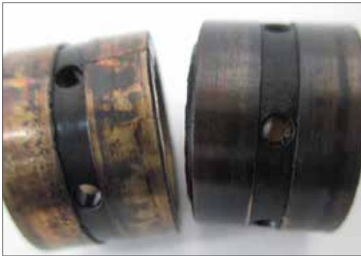
Fig. 13.1.1.1 – Lubrificação deficiente nos mancais radiais.
