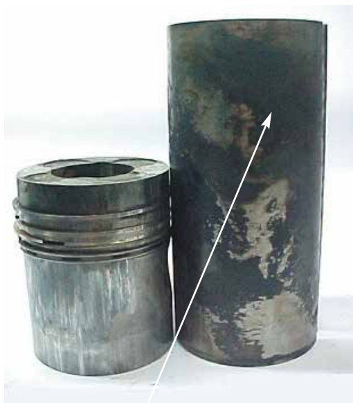
Fig. 5.2.1 Marcas escuras no lado externo da camisa, identificando a falta de interferência com o alojamento
