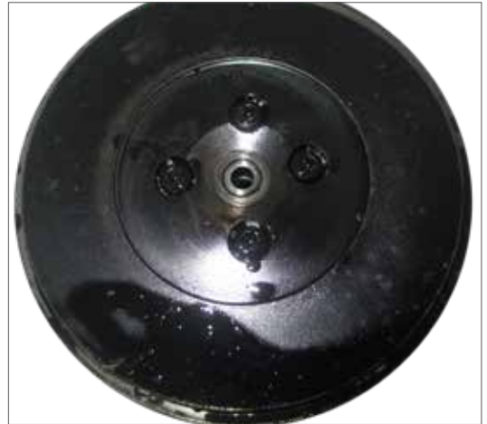
Fig. 13.5.2 – Óleo lubrificante no prato, provocado por restrição de ar.
