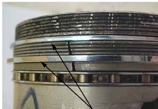
Fig. 2.15.2 Parede entre canaleta fraturada em pistão aplicado em motor Ciclo Otto
