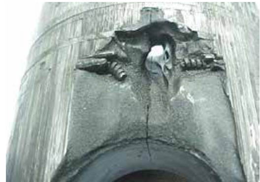
Fig. 2.7.11 Destruição do topo e da região do cubo devido ao bico injetor com funcionamento irregular
