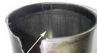
Fig. 6.3 Desgaste e risco provocados por partículas sólidas admitidas para dentro do cilindro
