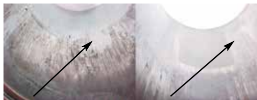
Figs. 5.3.1 e 5.3.2 Engripamento originado pela diluição do óleo lubrificante existente na parede do cilindro
