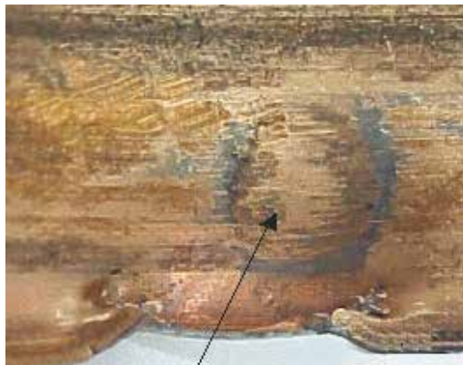
Fig. 10.2.5 Marca interna provocada pelo corpo estranho
