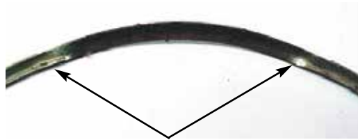
Fig. 3.4.1 Anel montado torcido
