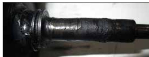
Fig. 13.1.1.7 – Eixo com excesso de carvão.
