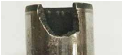
Fig. 12.4.3 – Detalhe da quebra do diâmetro interno
