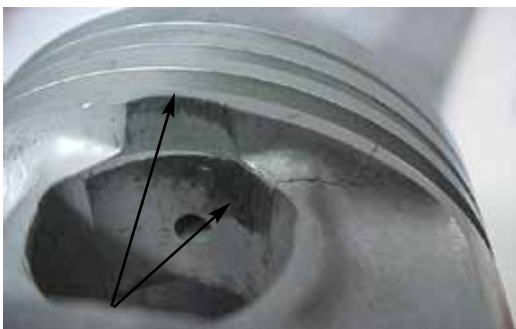
Fig. 2.14.2 Marcação irregular do pino no cubo durante o embielamento
