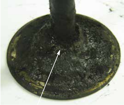
Fig. 11.9.3 Válvula de admissão com contaminação de crosta de óleo lubrificante devido à folga excessiva entre guia e haste e/ou deficiência do retentor/vedador
