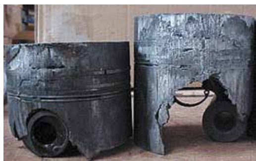
Fig. 2.6.7 Engripamento iniciado na zona de fogo com posterior ruptura na região do cubo
