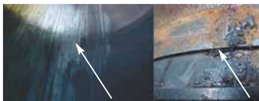
Figs. 5.2.2 e 5.2.3 Engripamento originado devido ao deslocamento do anel O'ring. Impureza no alojamento do anel O'ring na camisa
