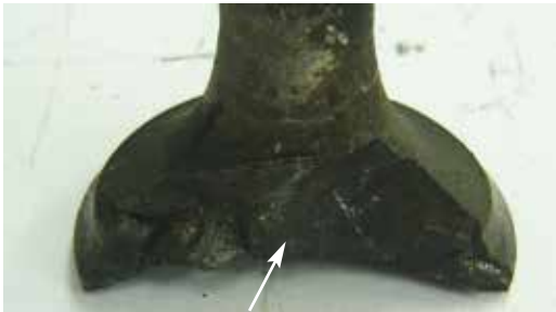
Fig. 11.6.1 Quebra de parte da cabeça
