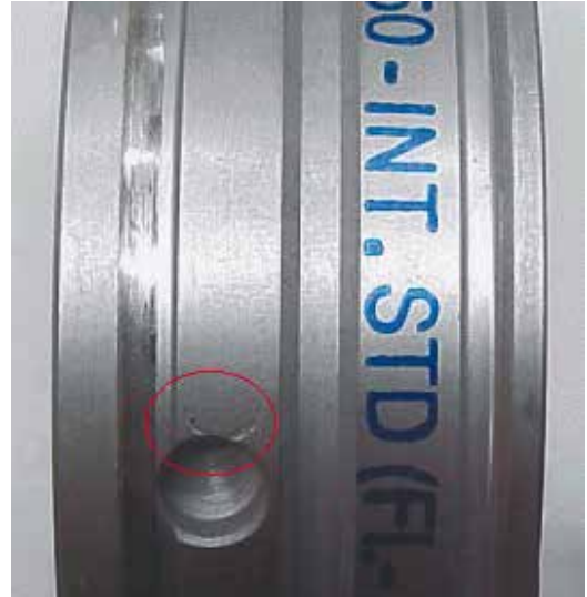
Fig. 8.13.1 Marca do pino na parte externa da bronzina
