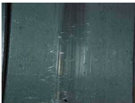
Fig. 8.2.8 Bronzinas de biela contaminadas e com riscos circunferenciais na direção do furo de lubrificação
