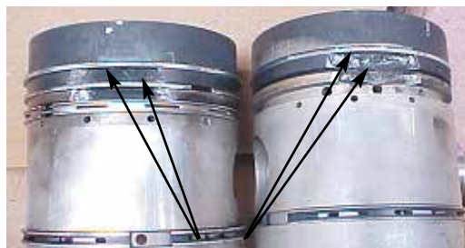
Fig. 2.15.3 Paredes entre canaletas fraturadas em pistões aplicados em motores Ciclo Diesel
