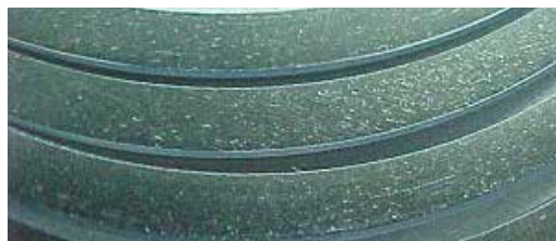
Fig. 3.5.5 Anel com partículas abrasivas na lateral
