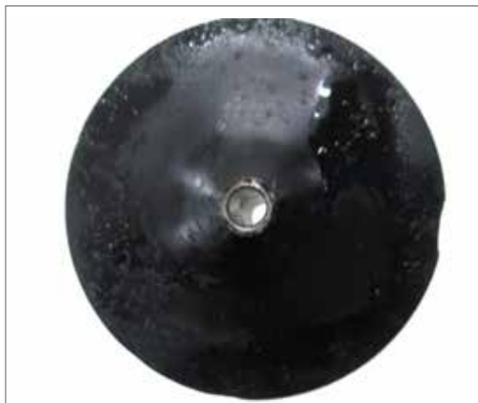
Fig. 13.5.1 – Borra de óleo lubrificante, provocado por restrição de ar.
