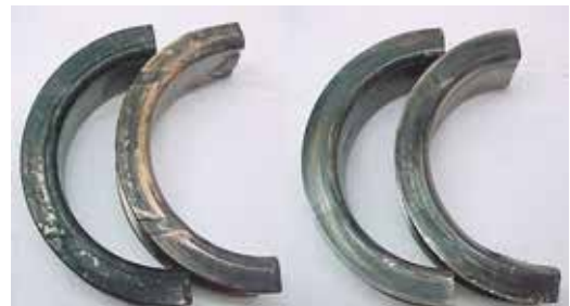
Fig. 8.1.3 Flange do lado dianteiro da bronzina sem desgaste e do lado traseiro com desgaste
