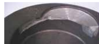
Fig. 2.13.5 Usinagem do rebaixo de válvulas
