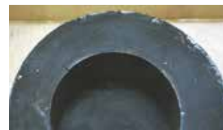
Fig. 2.13.6 Trincas existentes na borda da câmara de combustão
