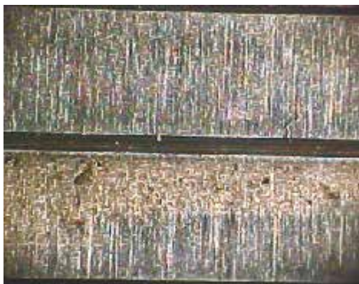
Fig. 3.5.1 Anéis com riscos na face de contato
