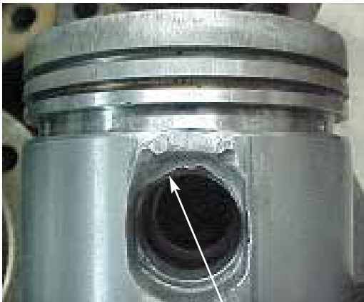
Fig. 6.2 Desgaste do pistão na região do cubo e topo provocado pela trava
