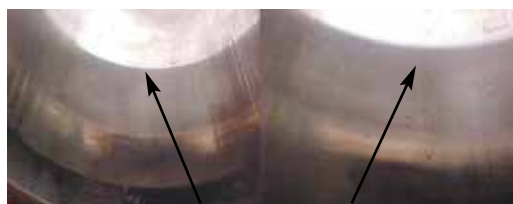
Fig. 5.3 Camisa "espelhada" devido à rotação constante
