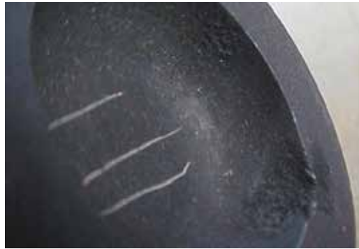
Fig. 2.7.2 Destruição parcial da câmara de combustão
