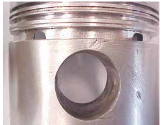
Fig. 2.14.4 Marca irregular próxima ao cubo
