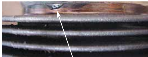
Fig. 4.1 Camisa montada com cola na superfície de apoio com o cabeçote (lado superior da camisa)
