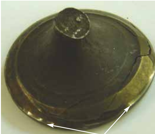
Fig. 11.3.2 Cabeça da válvula quebrada na região do raio e haste
