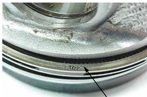
Fig. 3.1 Marca do anel montado para o lado de baixo
