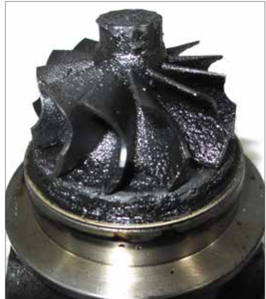
Fig. 13.4.2 – Óleo no rotor da turbina.
