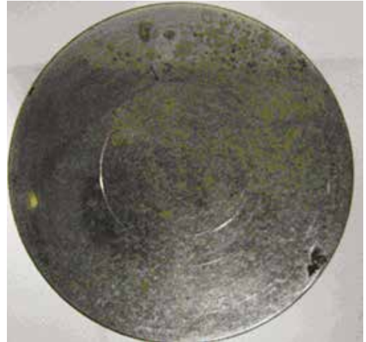
Fig. 12.2.2 – Várias regiões da base com ocorrência de Pitting
