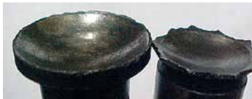
Fig. 12.4.4 – Detalhe de desgaste e quebra da base
