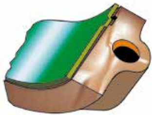
Fig. 9.4 Ressaltos de centragem não-coincidentes
