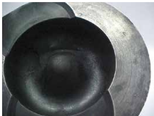
Fig. 2.13.1 Marcas de usinagem do topo do pistão
