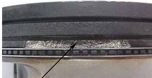
Fig. 2.15.1 Parede entre canaleta quebrada em pistão aplicado em motores Ciclo Otto
