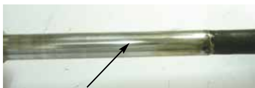
Fig. 11.1.1 Engripamento na região inferior da válvula
