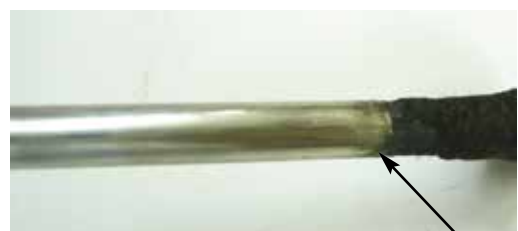
Fig. 11.1.4 Engripamento em função de resíduos de carvão fixados na haste
