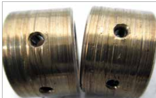
Fig. 13.1.2.1 – Riscos provocados por óleo lubrificante contaminado.
