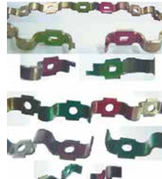
Fig. 3.7.2.9 Forma e cores das pontas da mola nova (sem retrabalho)
