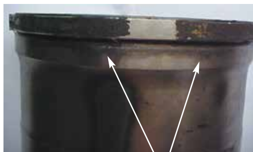
Fig. 4.1.1 Cola na região do colarinho da camisa
