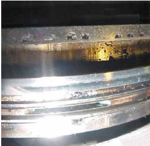
Fig. 3.6.5 Deslocamento da cobertura do anel
