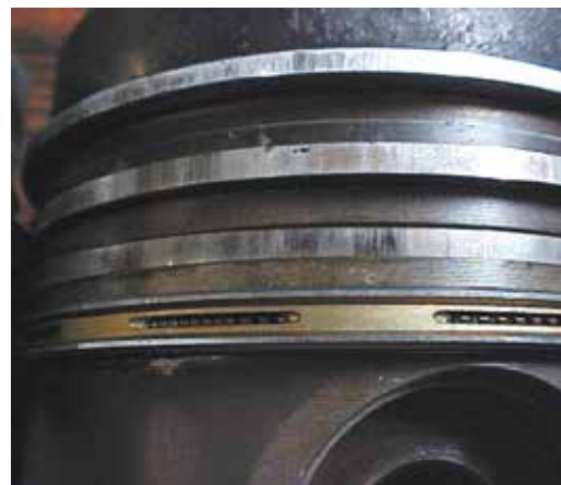
Fig. 2.7.5 Engripamento iniciado na zona de fogo
