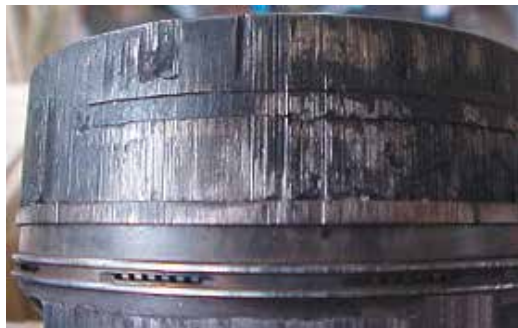
Fig. 2.7.8 Engripamento iniciado na zona de fogo
