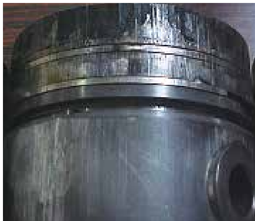
Fig. 2.7.9 Engripamento iniciado na zona de fogo
