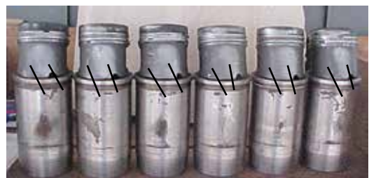
Fig. 1.3.4 Marcação inclinada na região da saia do pistão
