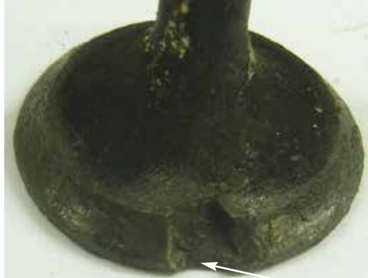
Fig. 11.8.1 Desintegração localizada na região do assento da válvula
