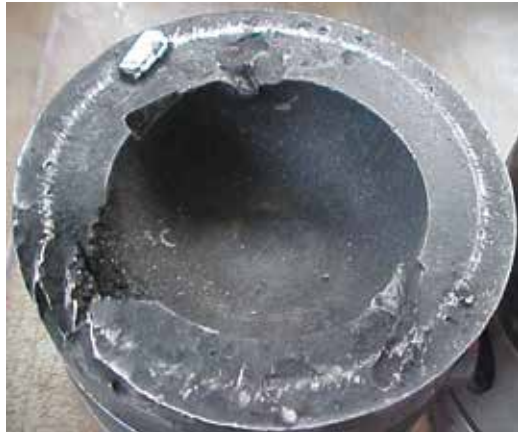
Fig. 2.7.7 Destruição parcial do topo devido à injeção
