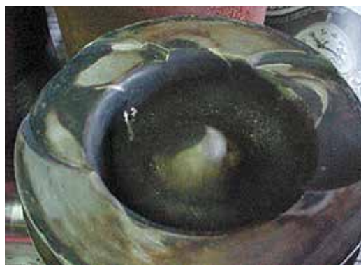
Fig. 2.6.4 Pulverização irregular do bico injetor
