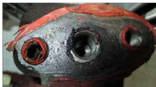
Fig. 13.1.1.8 – Obstrução da passagem de óleo lubrificante do turbo.
