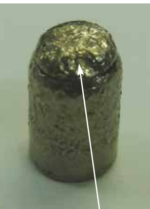
Fig. 11.4.1 Quebra na região do canal de trava
