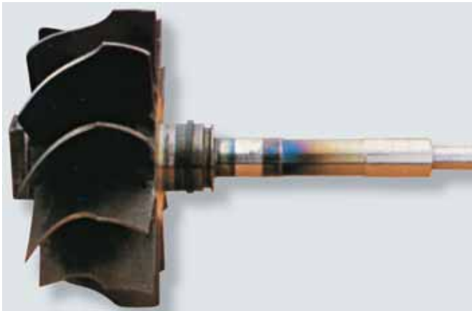
fig. 4.1 azulamento do eixo devido a aumento de temperatura causado por falta de lubrificante
