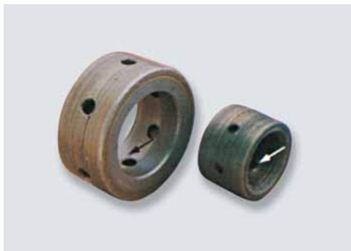
fig. 4.10 lubrificante contaminado pode danificar também o diâmetro interno dos mancais
