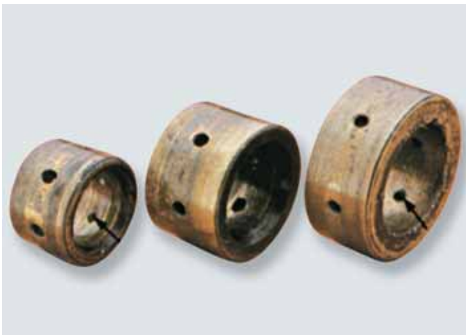
fig. 4.3 mancais radiais com furos de passagem de óleo obstruído
