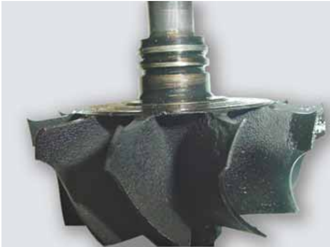
Exemplo de esforço axial no sentido Turbina Compressor.
