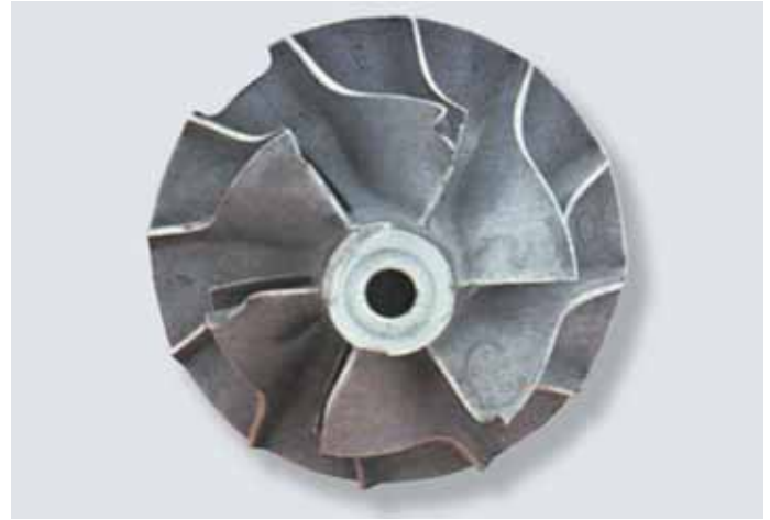
fig. 4.14 ingestão de material macio como estopa, pedaços de borracha, etc
