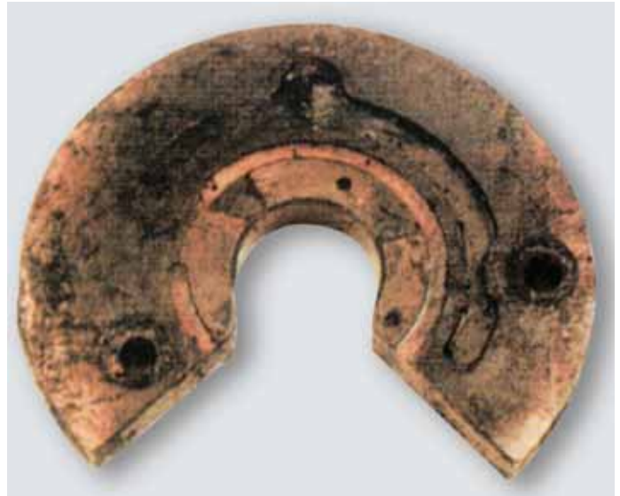
Mancal de encosto com depósito de óleo carbonizado (alta temperatura ou má qualidade do óleo)
