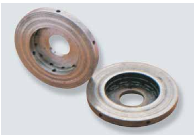
fig. 4.11 colar danificado por trabalhar com lubrificante contaminado
