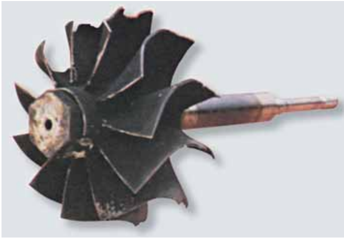
fig. 4.13 rotor da turbina danificado por objeto estranho
