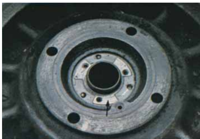
fig. 4.12 mancal de encosto do prato danificado por lubrificante contaminado
