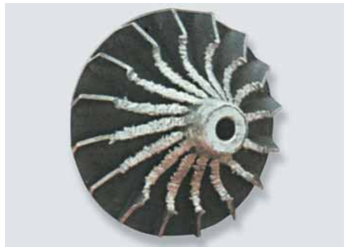
fig. 4.16 exemplo típico de ingestão de objeto estranho como porca, arruela, etc
