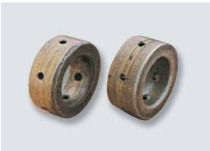
fig. 4.9 mancais radiais danificados devido a lubrificante contaminado
