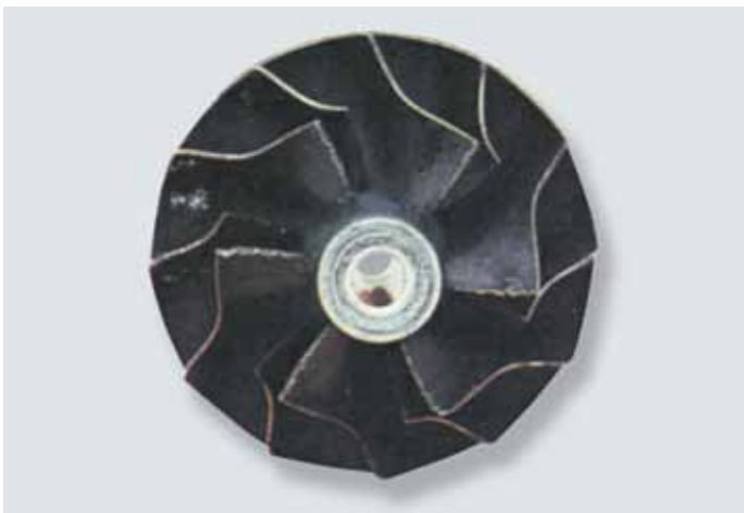
fig. 4.17 ingestão de poeira pela não utilização de filtro de ar
