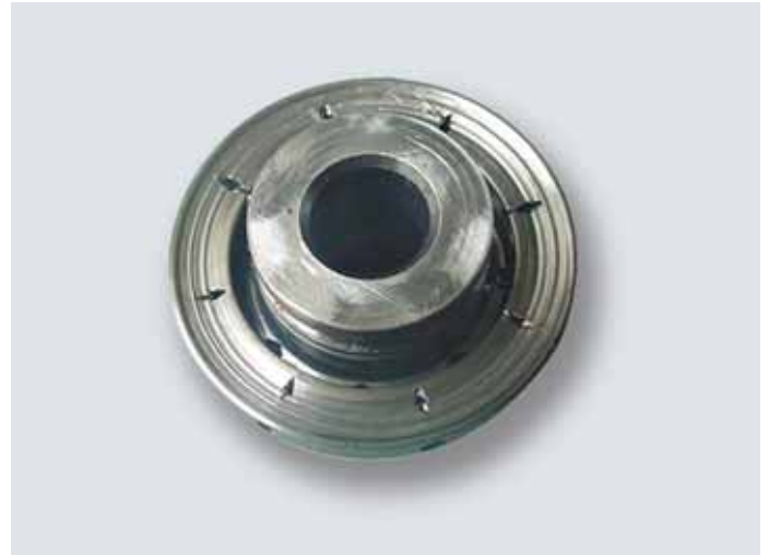
Desgaste devido ao atrito entre colar e face do prato.
