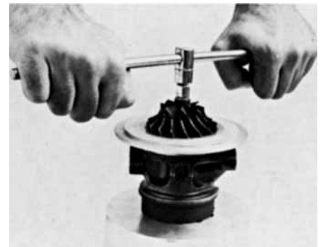
fig. 3.1 uso de la llave "T" para desajustar la tuerca autofrenante
