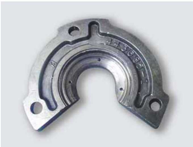
Desgaste das rampas de lubrificação devido ao atrito com o colar.
