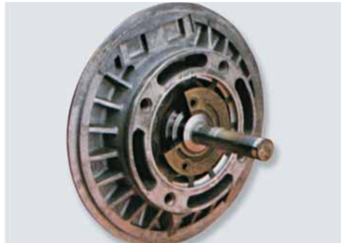
fig. 4.4 ruptura do eixo devido à falta de lubrificante
