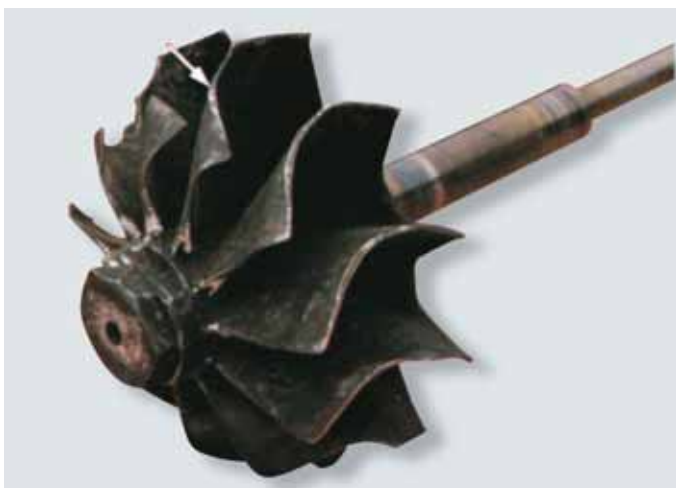
fig. 4.5 roçamento do rotor da turbina devido à falta de lubrificante
