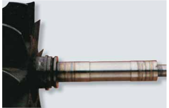
fig. 4.2 deposição do material do mancal radial no eixo
