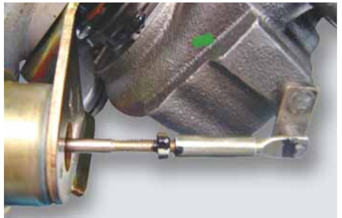
Exemplo de rompimento de lacre da porca de ajuste da haste do Atuador
