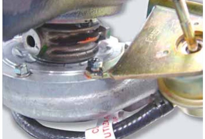
Violação do parafuso de fixação do Suporte do Atuador
