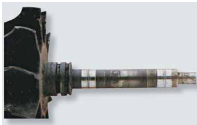
fig. 4.8 riscos profundos nos colos dos mancais causados por contaminante
