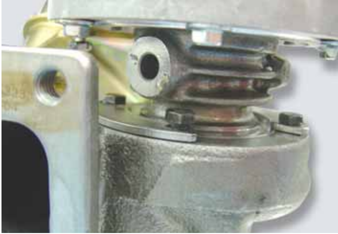
Violação do parafuso de fixação da Carcaça da Turbina
