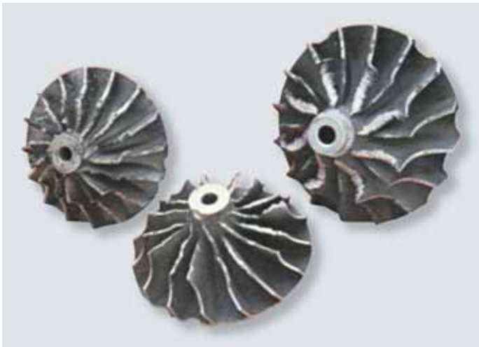
fig. 4.15 exemplos típicos de ingestão de objeto estranho
