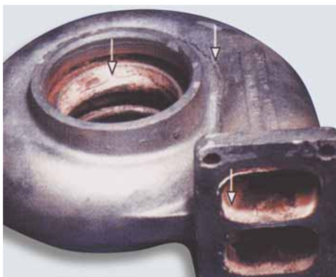
Alta temperatura trinca a carcaça da turbina, muda sua cor ou provoca descamação de material nas superfícies internas
