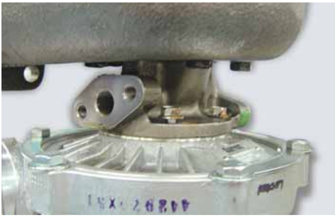
Violação do parafuso de fixação da Carcaça Central no Prato
