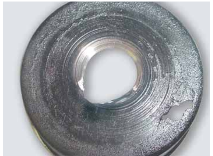
Proteção térmica danificada pelo atrito com o Rotor da Turbina causado pelo esforço axial.- Excesso de Fumaça
