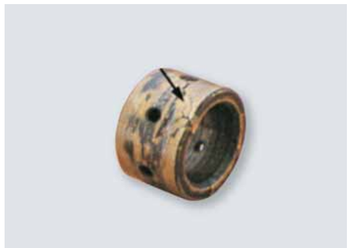
fig. 4.6 mancal radial com trinca devido ao superaquecimento
